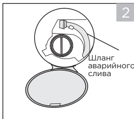
Выньте шланг аварийного слива, вытащите заглушку
