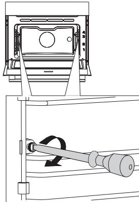
**1** Открутите винты с помощью отвертки.
