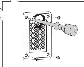
**1** Открутите четыре винта на крышке. Снимите крышку и стекло.
