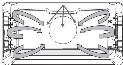
В данном режиме работают микроволны и вентиляционный нагрев.
