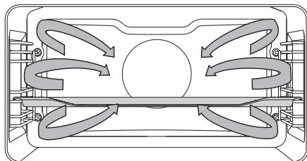
Одновременно работают нагревательный элемент вокруг вентилятора и вентилятор.
