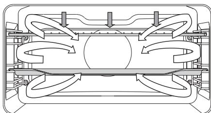
Одновременно работают верхний нагревательный элемент, инфранагреватель и вентилятор.
