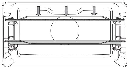
При **большом гриле** включаются верхний нагревательный элемент и инфранагреватель, расположенные под потолком духовки.
