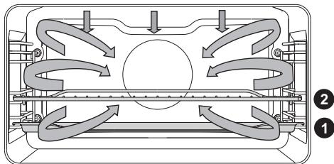
Одновременно работают верхний нагревательный элемент, инфранагреватель и нагревательный элемент вокруг вентилятора. Используется для приготовления всех видов мяса.
