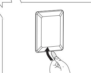
**1** С помощью отвертки снимите крышку.
