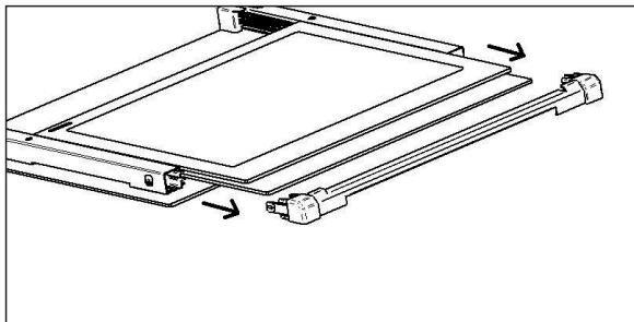
**ВНИМАНИЕ: ОБЯЗАТЕЛЬНО ЗАБЛОКИРУЙТЕ ПЕТЛИ (СМ СНЯТИЕ/УСТАНОВКА ДВЕРИ ДУХОВОГО ШКАФА) ПЕРЕД НАЧАЛОМ ИЗВЛЕЧЕНИЯ СТЕКОЛ ВО ИЗБЕЖАНИЕ СЛУЧАЙНОГО ЗАКРЫТИЯ ДВЕРИ И ПОВРЕЖДЕНИЯ СТЕКОЛ!**
