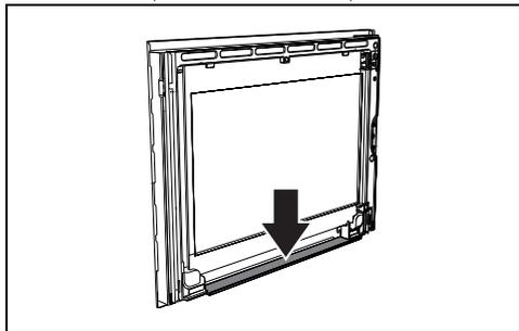
4. Завершив очистку, установите на место внутреннее стекло. Обращая внимание на тщательную центровку 4 стержней, вставьте их в гнезда на дверце духовки, слегка надавив на них.
