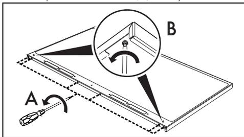
2. Установите планку на поверхности варочной панели. Совместите 6 отверстий на нижней части планки с ранее отвернутыми 6 винтами на задней части панели.
