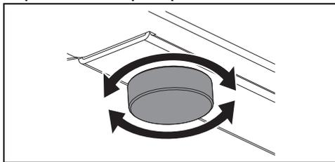
Чтобы обеспечить устойчивое положение прибора, необходимо правильно выровнять его на полу:
