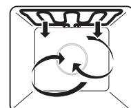
Воздух в камере прогревается нагревательным элементом, расположенным за задней стенкой камеры, и равномерно циркулирует.
